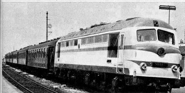
060 - G.A.1 — Locomotive à turbine à gaz. Constructeur : RENAULT - CAFL — 120 tonnes — 2 400 CV — 128 km/h.
