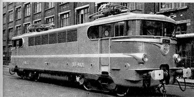
BB 9 400. Locomotive électrique 1 500 volts continu. Constructeurs : FIVES LILLE, C.E.M., S.W. — 60 tonnes — 3 000 CV — 120 km/h. Bogie monomoteur.
