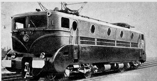
BB 9 200. Locomotive électrique : 1 500 volts continu. Constructeur : M.T.E. (S.F.A.C., JEUMONT, S.W.), C.E.M. — 84 tonnes — 5 500 CV — 160 km/h. La locomotive prototype BB 9 004 est co-détentrice du record mondial de vitesse : 331 km/h.
