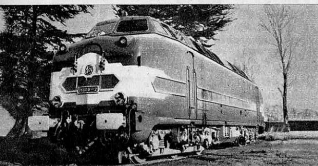
CC 060 DB. Locomotive Diesel-électrique. Constructeurs : ALSTHOM, C.A.F.L., Moteurs Diesel : 2 moteurs SACM (type MGO) — 112 tonnes — 1 800 CV — 130 km/h.
