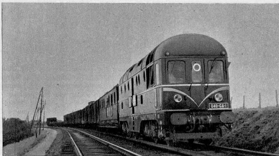
La locomotive à générateur à pistons libres et turbine à gaz.
