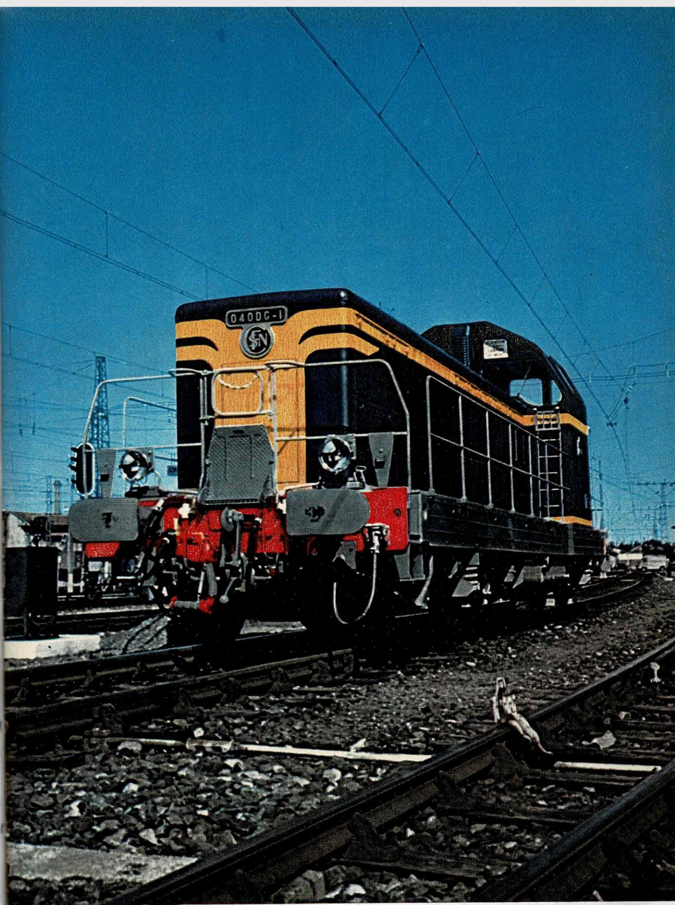
Locomotive diesel-électrique S.N.C.F. de 1 400 ch mise en service en 1960 — Voir page 110
