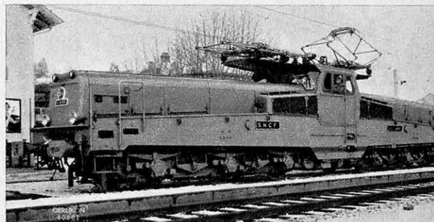
CC 14 001. Locomotive électrique 25 000 V — monophasé 50 Hz. Constructeur : BATIGNOLLES - OERLIKON — 120 tonnes — 4 100 CV — 60 km/h.
