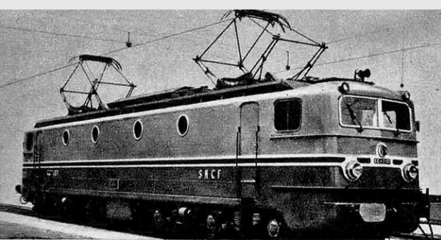
CC 7 100. Locomotive électrique : 1 500 volts continu. Constructeur : ALSTHOM — 107 tonnes — 5 000 CV — 160 km/h. La locomotive CC 7 100 est co-détentrice du record mondial de vitesse : 331 km/h.
