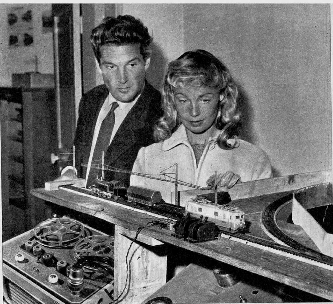
Le magnétophone classique trouve un emploi dans l'animation de maquettes : sur ce réseau miniature, il règle la marche des trains, fait les annonces en gare, etc.
