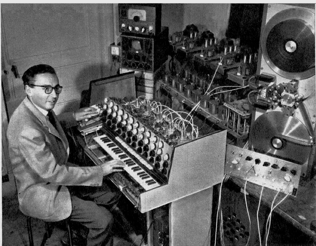
ORCHESTRE ROBOT composé d'une ondioline spéciale et d'un magnétophone à 8 pistes, présenté par Georges Jenny, l'inventeur de l'ondioline. Avec cet orchestre, le compositeur devient à la fois chef d'orchestre et musicien, enregistrant ligne par ligne la symphonie qu'il a conçue avec les nuances et les timbres infinis de l'ondioline. Il peut effacer, corriger, renforcer, jusqu'à ce que l'exécution corresponde exactement à sa pensée créatrice imitant en cela le peintre qui peut à chaque instant juger l'effet de ses retouches.
