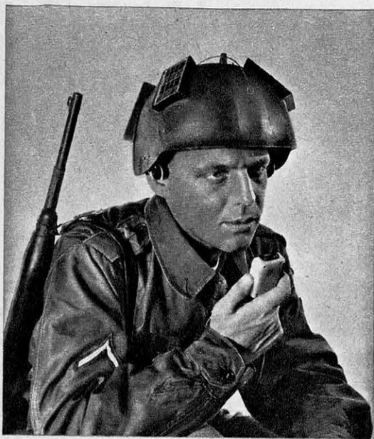
LE CASQUE FUTUR DU FANTASSIN comportera comme celui-ci, actuellement aux essais, un poste émetteur-récepteur alimenté par des piles solaires placées à sa surface et encadrant une petite antenne. Quatre petites batteries au cadmium-nickel emmagasinent l'énergie nécessaire au fonctionnement de l'appareil durant la nuit.
