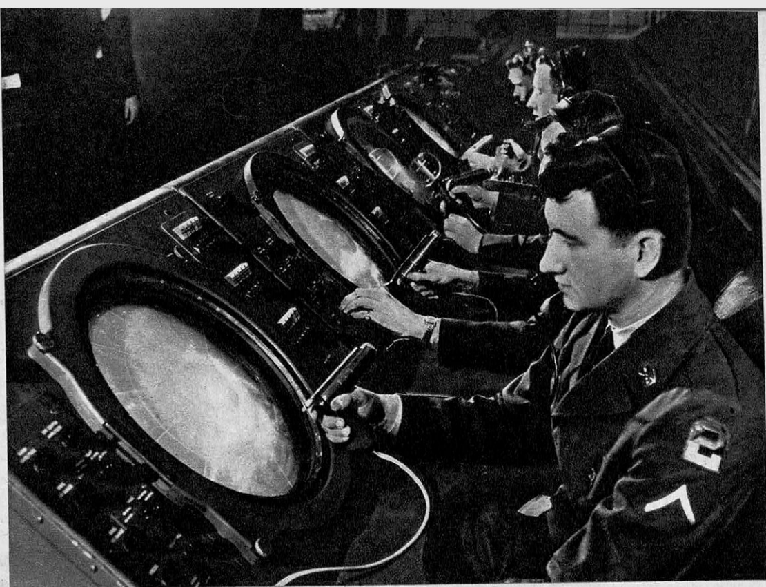
BATTERIE D'ÉCRANS RADAR de surveillance générale. Toute tache suspecte sera repérée à l'aide d'un pistolet photoélectrique spécial et, si besoin est, ses coordonnées seront envoyées à un système de poursuite.
