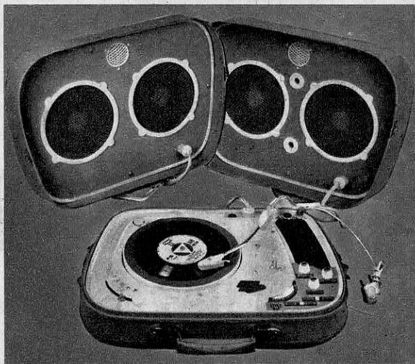
ÉLECTROPHONE STÉRÉOPHONIQUE Teppaz à 6 haut-parleurs et 4 vitesses. Suivant la place relative que l'on donne aux haut-parleurs, il est possible d'accroître ou de réduire l'effet stéréophonique.
