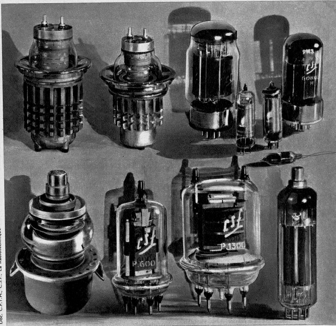
Les tubes électroniques adoptent des formes variées : en haut, des « vapotrons » de grande puissance (jusqu'à 300 kW), des doubles triodes et des régulateurs à cathode froide; en bas, une triode de 2 MW en régime d'impulsions pour amplificateurs à cavité, deux pentodes d'émission, une diode survolteuse monoplaque.
