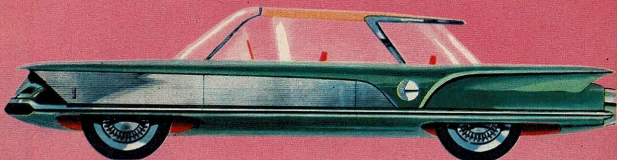
MENEHUNE II: grande minceur des montants également pour cette voiture qui, a le même châssis que la Menehune I, et peut transporter 4 passagers.
