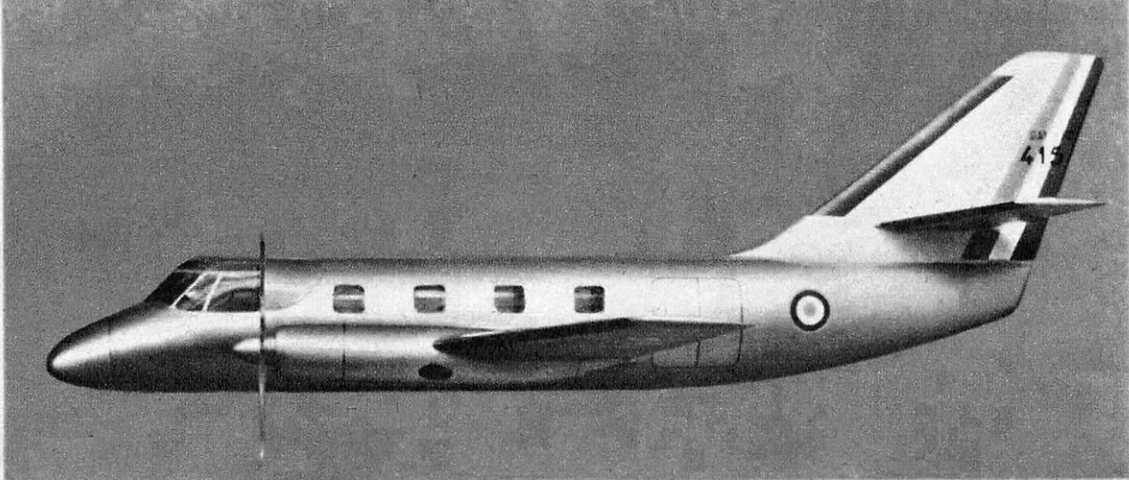
Le « Communauté » Dassault 415 est un avion de soutien qui groupe en une même cellule des possibilités d'attaque et de transport (10 passagers). Il est envisagé pour assurer la police et la sécurité dans les territoires d'outre-mer.
