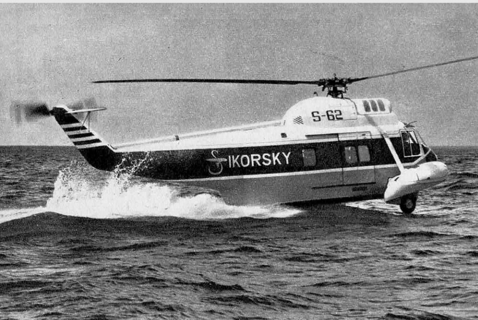
LE SIKORSKY S-62 est le premier hélicoptère amphibie à coque, avec 2 ballonnets latéraux. Il est équipé d'une turbine libre General Electric T 58. En version civile, il pourra emporter 25 passagers à environ 150 km/h sur des étapes de 450 km.
