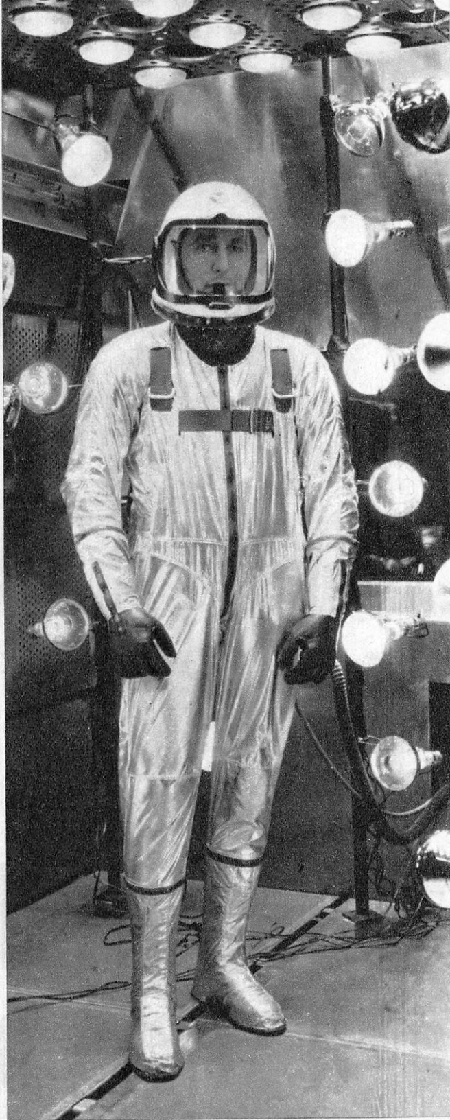
Scott Crossfield premier pilote d'essai de North-American, a revêtu la combinaison qu'il portera dans le X-15 et se soumet à l'épreuve des hautes températures sous le rayonnement de multiples lampes infrarouges.
