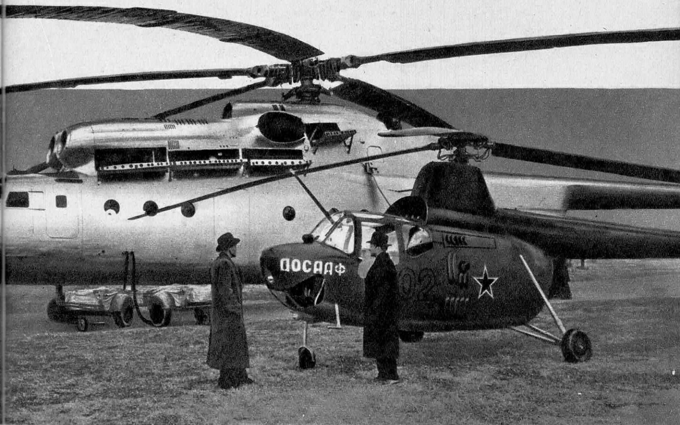
LE MI-6 russe, dont cette photographie permet d'apprécier la taille, est pour l'instant le plus gros du monde et le plus puissant. Son rotor à 5 pales est entraîné par deux turbines Soloviev de 4 700 ch. Il peut emporter de 80 à 120 passagers.
