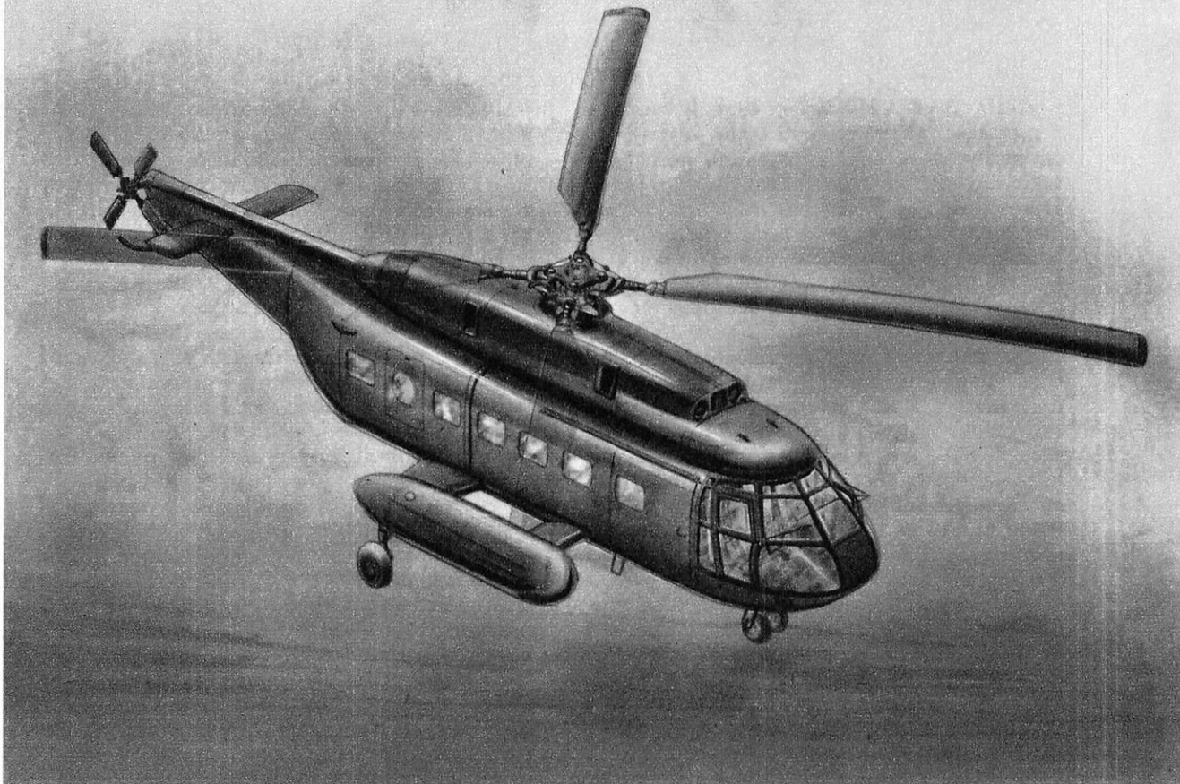
↑ LE « SUPER ALOUETTE » SE-3200 de 8 tonnes pourra transporter de 28 à 30 passagers. Il sera équipé de trois Turboméca « Turmo » III de 750 ch.
