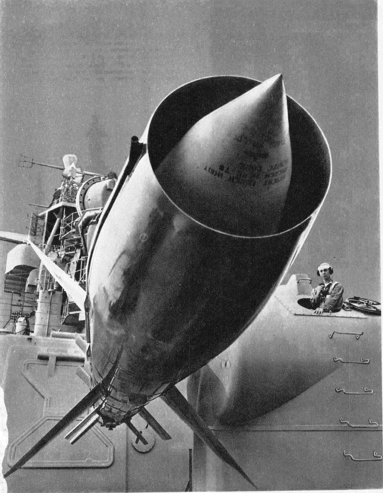
LE TALOS est un engin antiaérien qui équipe les bâtiments de l'U.S. Navy. Pesant 1 500 kg sans les deux fusées auxiliaires à poudre qui servent à son lancement, il atteint Mach 2,7 ; il peut être muni d'une ogive nucléaire.
