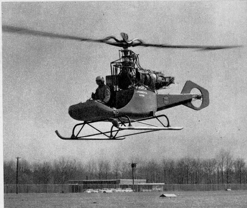
LE KAMAN 17 est un hélicoptère expérimental à 2 places étudié pour l'U.S. Army. Les deux pales du rotor sont actionnées par des jets d'air comprimé fourni par un compresseur Boeing 702 entraîné par turbine Blackburn Turmo 600.
