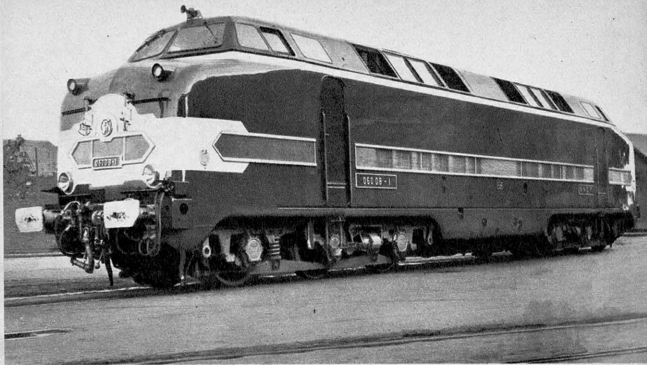
LOCOMOTIVE DIESEL ÉLECTRIQUE 060 DB destinée à remplacer les locomotives à vapeur; vitesse maximum, 130 km/h. Actuellement, la locomotive à vapeur la plus moderne, en service sur le réseau du Nord pour la remorque des trains rapides de voyageurs, est la 232 U qui peut atteindre 140 km/h.
