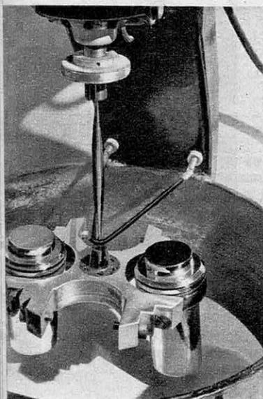
● Les filtres sont disposés dans un centrifugeur électrique.
