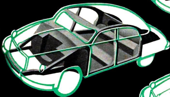
Construction monocoque : le châssis et la carrosserie sont réunis en une structure unique.
