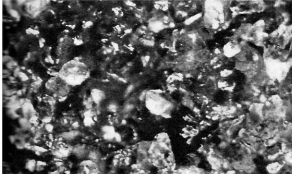
Filtre à air Técalémit en tissu flocké Fibrac. Photographies grossies 58 fois montrant des grains de poussière retenus à la surface externe (à gauche) et interne (à droite) par les déchets de laine adhérant à l'armature.
