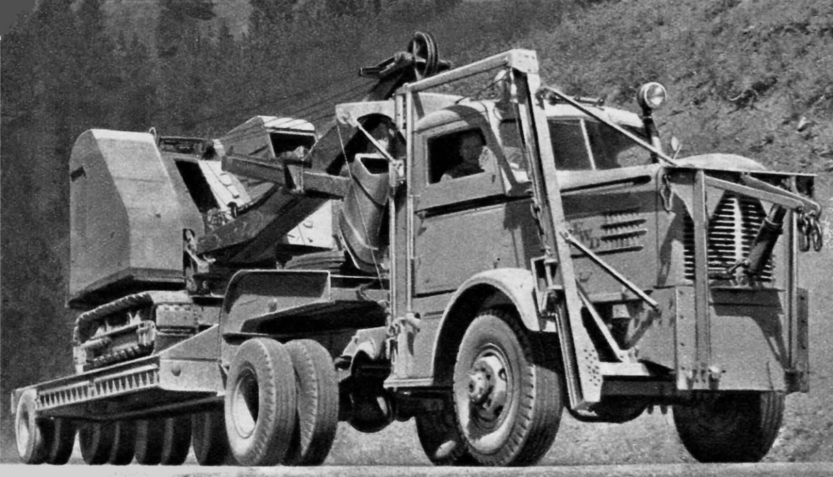
TRACTEUR FWD M 4 x 4. 2 ESSIEUX MOT. EQUIPE POUR TRANSPORT DE MATERIEL DE GENIE CIVIL.
