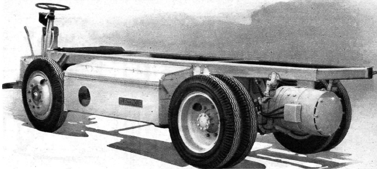
CHASSIS SOVEL AB 2 VS. POIDS : 1 970 KG. POIDS BATTERIES : 1 800 A 2 300 KG. C. UTILE : 2,9 T A 3,4 T
