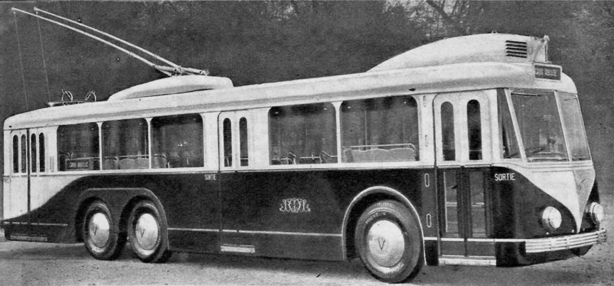
TROLLEYBUS VETRA, TYPE VA3, A 3 ESSIEUX. LONG. 12 METRES. 120 PLACES. PUISSANCE : 130 CH.
