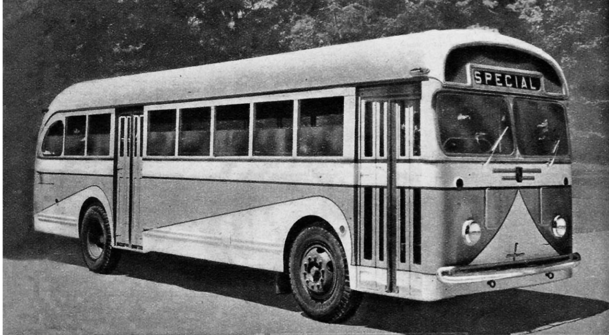
AUTOBUS REO, 33 PL. MOTEUR A ESS. 127 CH. MONTÉ HORIZONTALEMENT AU MILIEU DU CHASSIS.
