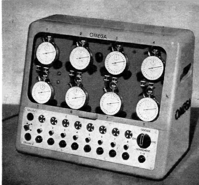
Appareil universel de chronométrage à huit chronographes pour les épreuves sportives (Oméga).
