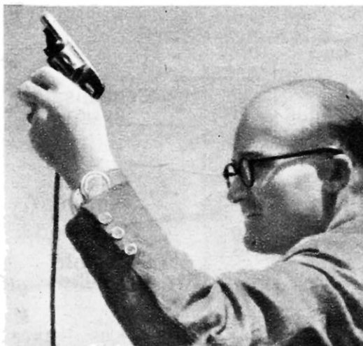
Le pistolet de start relié électriquement au coffret des chronographes installé à l'arrivée.
