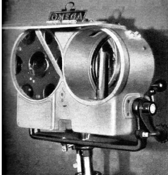
Projecteur (à gauche) et cellule (à droite) pour le chronométrage photoélectrique (Omega)
