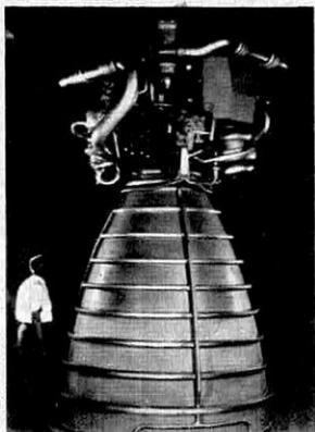
Deux moteurs-fusées à hydrogène sont actuellement développés : le « SSME », à gauche, de l'Orbiter de la navette spatiale aux USA et le « HM7 » du 3 e étage du lanceur lourd Ariane, en France.
