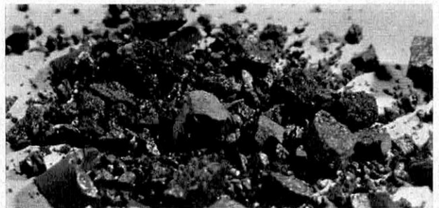
2 g d'hydrure de Mischmetall-Cobalt 5 : 0,4 l d'hydrogène.
