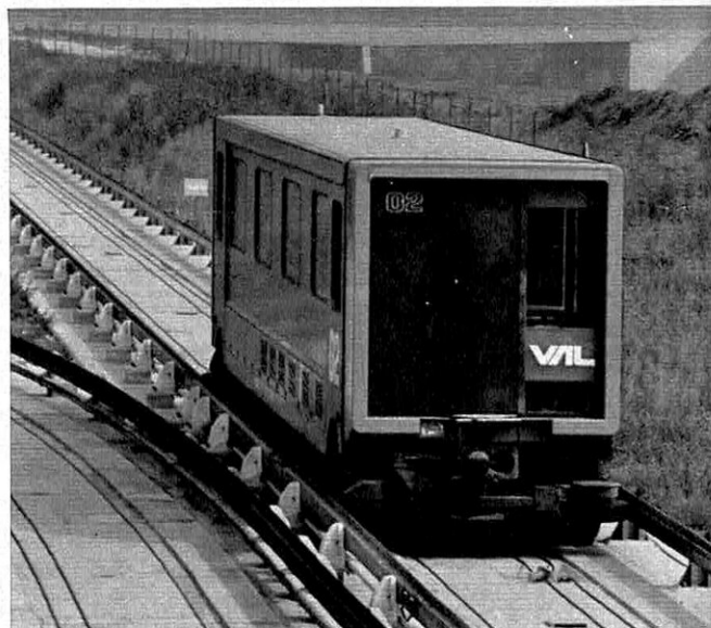
Le prototype 02 effectue ses essais au sol. La voie double définitive sera aérienne.
