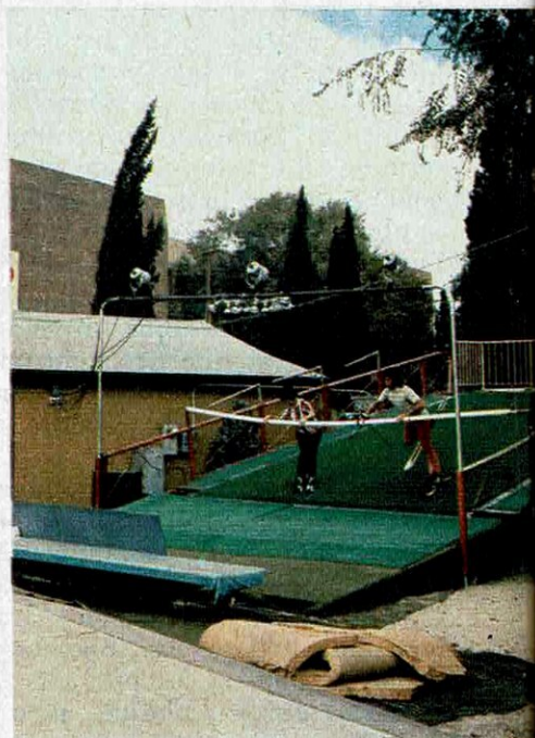
Le système ne réclame pas de longues pistes, un tapis de 12 m enroulé sur deux cylindres suffit amplement.
