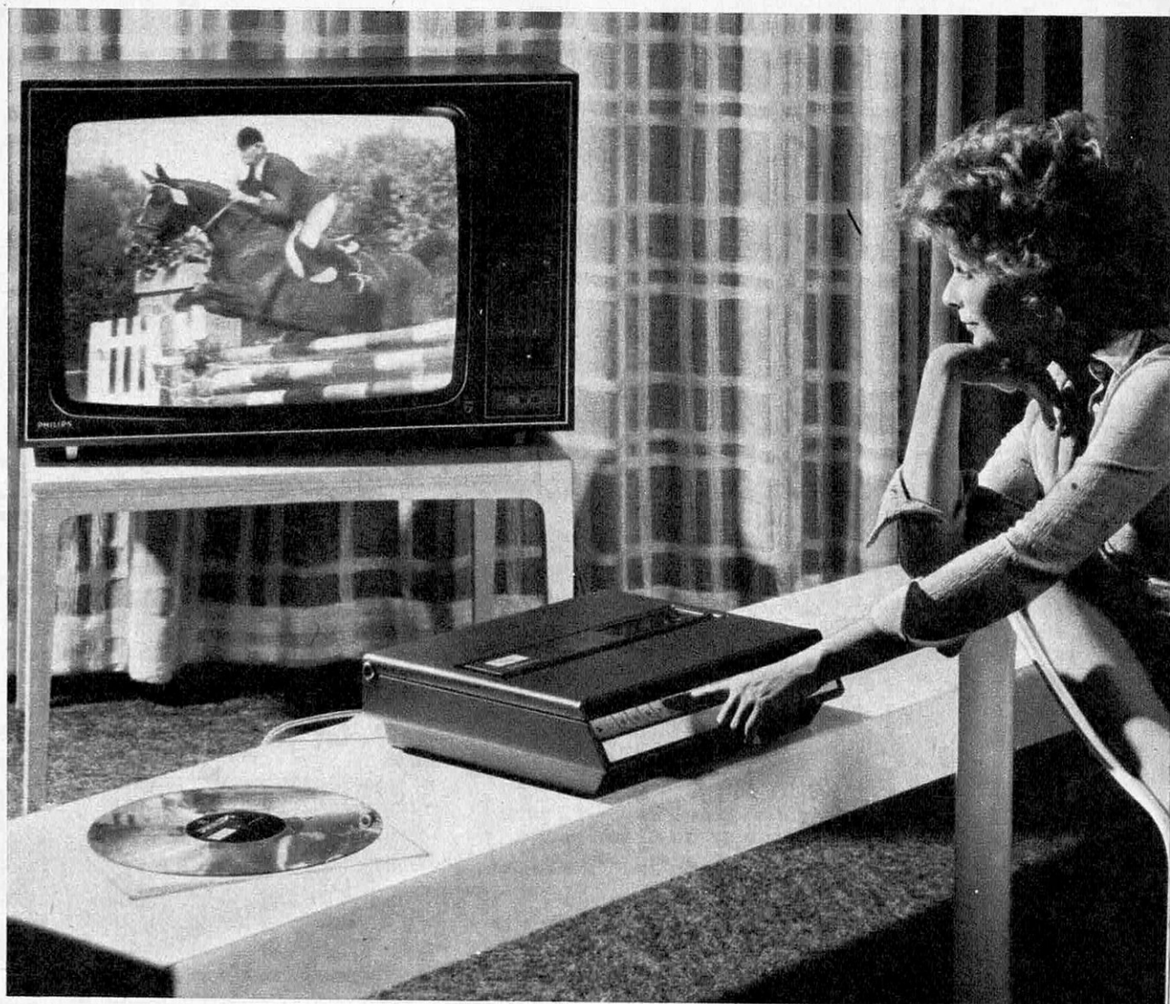
Accéléré, ralenti, marche arrière : tout est possible avec le système VLP Philips : un disque de 45 000 images, tournant à 1 500 tr/mn et analysé par une aiguille de lumière.
