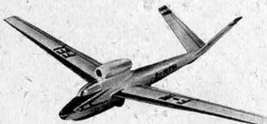
**FOUGA « SYLPHE »** avion à réaction pour le sport, voyage et recherche scientifique, envergure 655 mm. Peut être équipé avec le réacteur JETEX 50.
