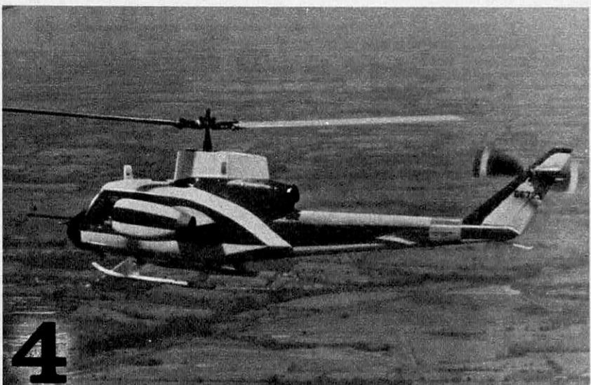
**DES AILES ET DES REACTEURS :** 1962 — Un Bell « Iroquois » est modifié de cette façon. Avec 1 100 ch, le rotor, soulagé, permet d'atteindre 402 km/h en essais.
