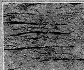
FIG. 7 G = 400 Structure du support de la Lise Dunham finie par le fabricant (présence d'inclusions)
