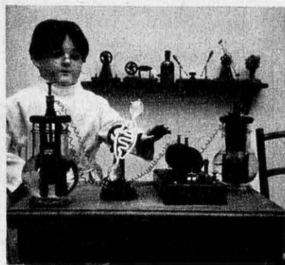
Piles-bouteilles, bobine de Ruhmkorff et... rayons X pour amateurs en vente dès 1900 !
