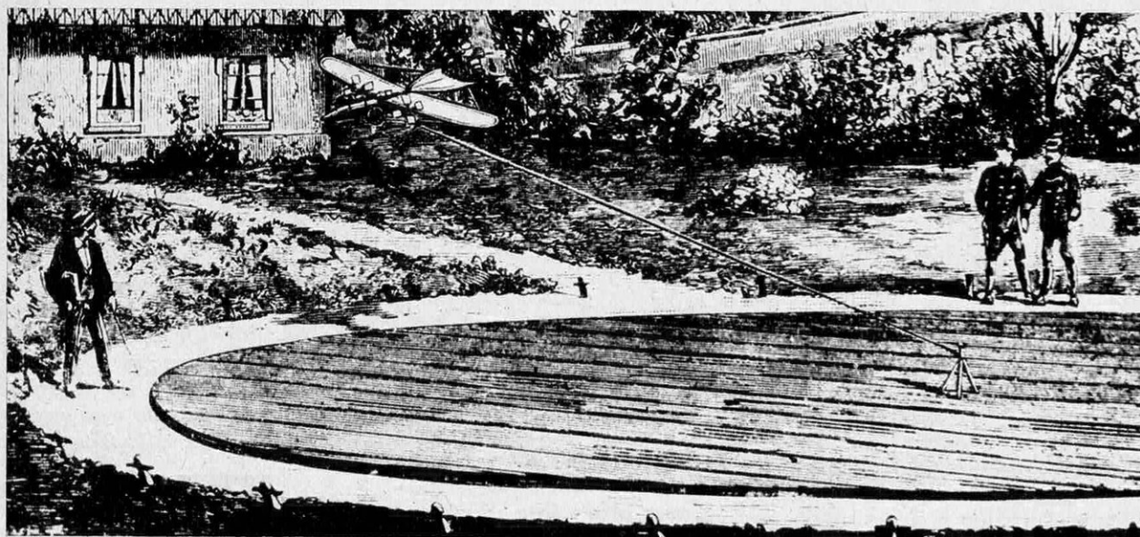
De l'expérience de Victor Tatin sur un aéroplane à air comprimé, à Chalais-Meudon, en 1879, il nous reste cette gravure d'époque et l'appareil lui-même, conservée au Musée de l'Air de Chalais.
