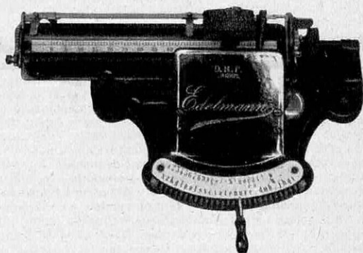
Modèle Edelmann à tête d'impression cylindrique.
