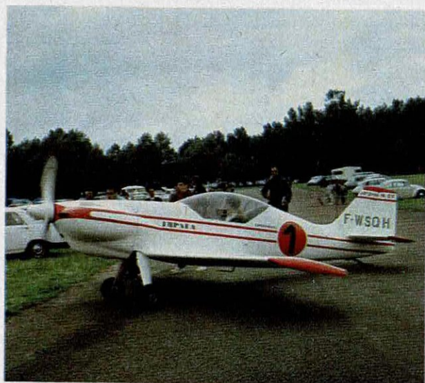
Racer français , l'« Impala » de 90 ch réalisé en plastique s'imposera en 1971...
