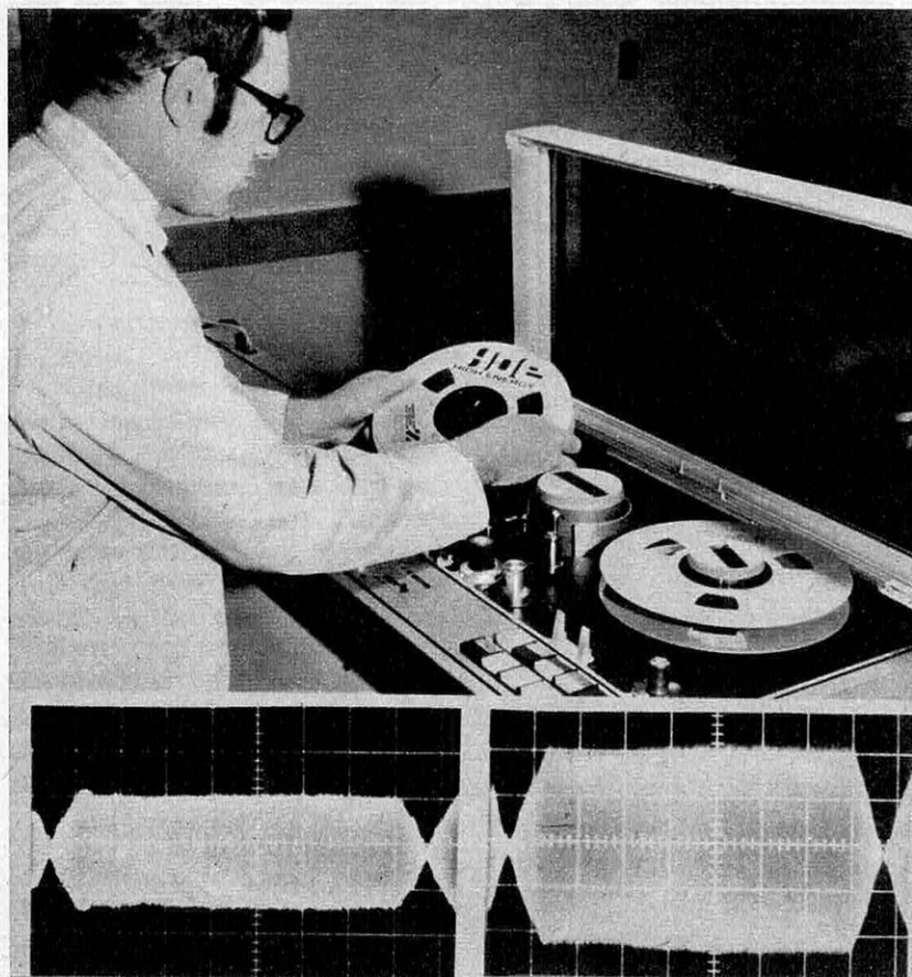
L'oscilloscope montre (à droite) le gain en niveau de sortie par rapport à une bande standard.
