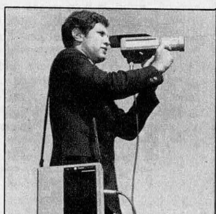
Ensemble de prise de vue Amplex. Dans la caméra se trouve un petit tube cathodique qui permet de cadrer l'image et d'effectuer la mise au point.
