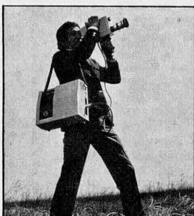
Équipement portable JVC Ni-vico. Au-dessus du zoom on remarque un petit microphone, pour les bruits d'ambiance. Un autre micro commutable destiné au commentaire, se trouve face à la bouche de l'opérateur.
