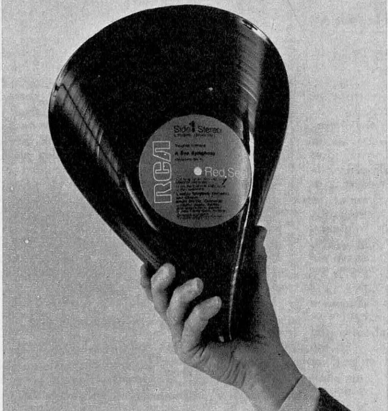
Le gondolage est pratiquement éliminé avec les disques Dynaflex qui sont en matière souple. Celle-ci, très élastique revient d'elle-même en position plane sur le plateau du tourne-disque. Cette meilleure planéité assurée au disque élimine pratiquement les effets de pleurage (sauf bien entendu, ceux qui seraient dus à des imperfections de lecture).
