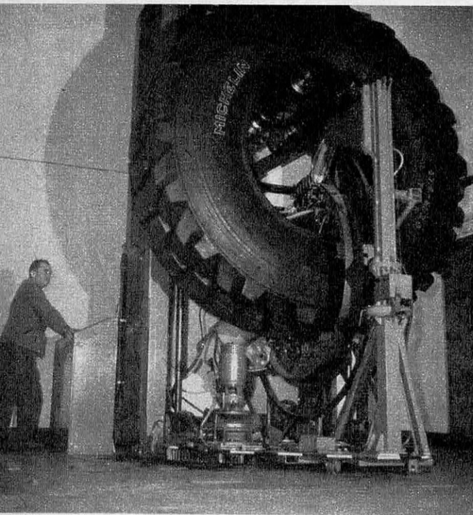
Essais mécaniques en chambre : une première étape seulement, avant les essais sur route.
