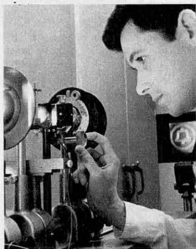
Ce spécialiste des laboratoires Bell focalise sur un petit écran le sigle de sa compagnie projeté à partir d'un « ferpic ».
