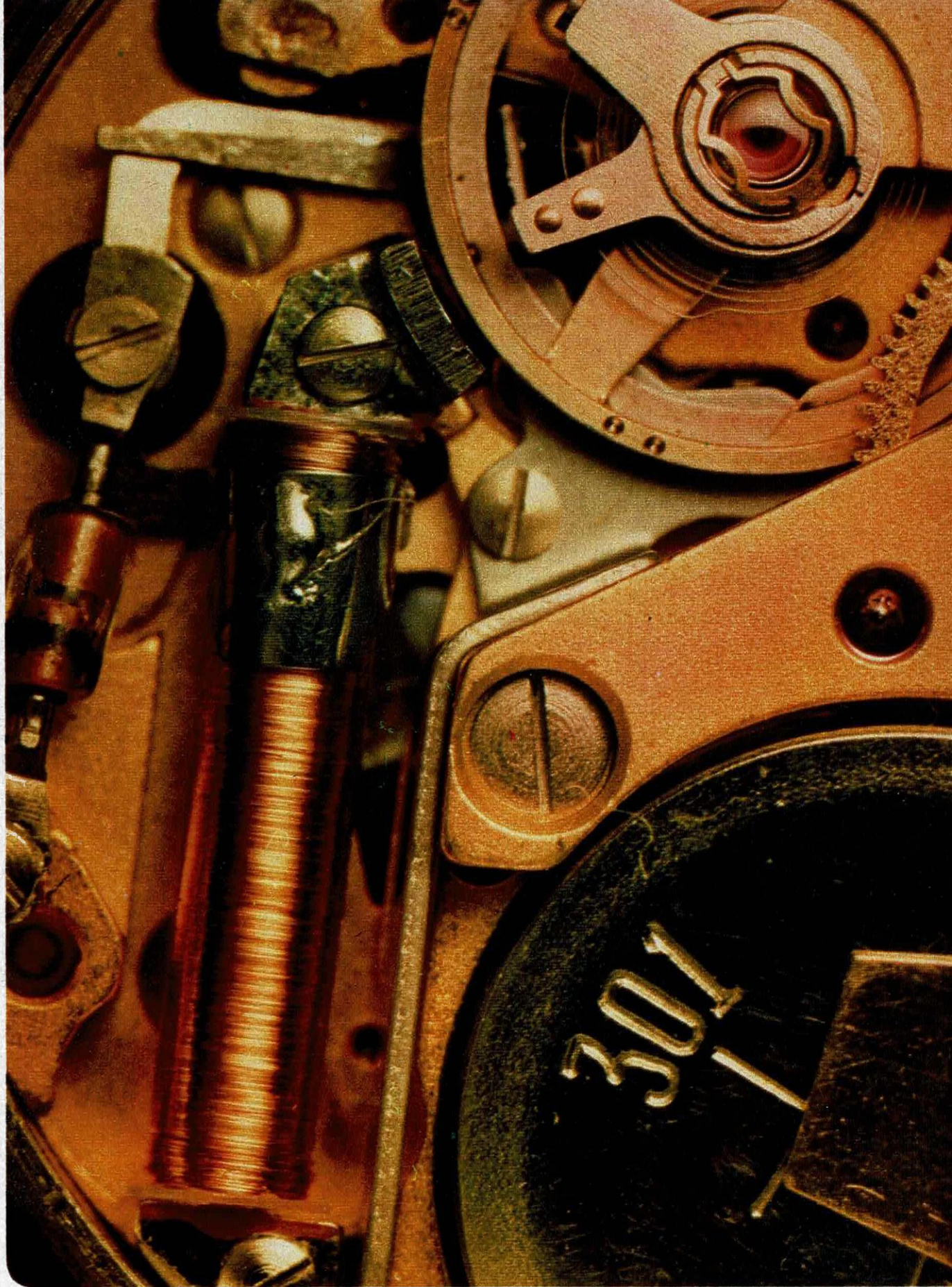
LA MONTRE ÉLECTRIQUE. Ici c'est toujours un balancier conventionnel qui assure la division du temps, mais ses oscillations sont entretenues électriquement. L'énergie vient d'une pile.
