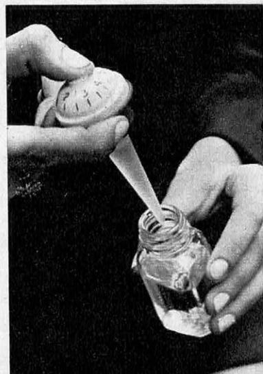
Il s'agit d'un compte-gouttes en plastique, qui a le mérite d'être infaillible, même si la main est inexperte. Il se compose d'une pipette, d'un cadran gradué et d'un bouton. L'utilisateur compose sur le cadran le nombre de gouttes, appuie sur le bouton et la quantité désirée est aspirée dans la pipette. Pour la libérer il suffit d'appuyer, à nouveau, sur le bouton.
