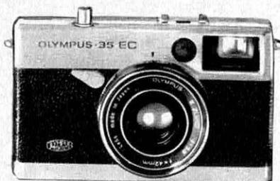
L'Olympus 35 EC est un nouvel appareil 24 x 36 mm de faible volume (111 x 67 x 49 mm et 400 g) dont le fonctionnement est entièrement électronique. Une cellule CdS règle en effet un obturateur électronique selon un programme séquentiel de 4 secondes à  $f = 2,8$  jusqu'au  $1/800$  de seconde à  $f = 13$ . Le 35 EC comporte également un réglage automatique au flash
