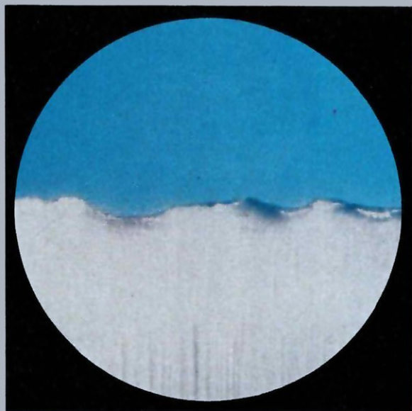
Une lame ordinaire après 5 rasages : son fil est oxydé, ce n'est plus qu'une râpe. (grossissement 240 fois).
