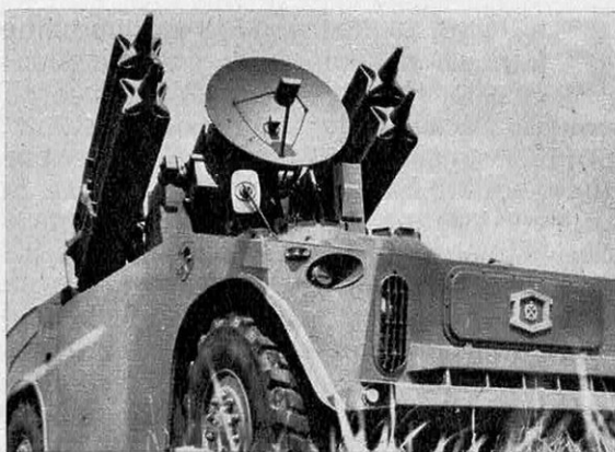
Le système d'armes Sol-Air Crotale , réalisé sous la maîtrise d'œuvre de Thomson-Houston, dont le missile est construit par Matra, équipera en 1971 les armées françaises et d'Afrique du Sud. Le système est formé de deux véhicules : le premier est équipé d'un radar de surveillance et de désignation d'objectif et d'un ordinateur digital. Il est couplé à un ou plusieurs véhicules lanceurs équipés d'un radar de tracking, d'un ordinateur digital et d'une rampe orientable permettant de tirer 4 missiles à la vitesse de Mach 2,3 sur des cibles éloignées de 8 km.
