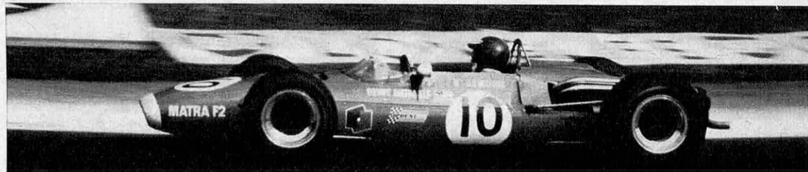
La Matra formule 2, type M.S. 7, à moteur Ford 1600, qui permit en 1968 à Jean-Pierre Beltoise et à Henri Pescarolo de terminer respectivement premier et second du championnat d'Europe. Ces voitures ont dominé en formule 2 de 1967 à 1969, avant d'être retirées des compétitions, parce que n'étant plus conformes aux normes de la Fédération.
