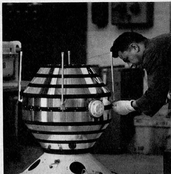
La capsule technologique A1, première charge française satellisée le 26 novembre 1965, a été réalisée sous la maîtrise d'œuvre de Matra. Elle a fourni au sol toutes les informations nécessaires sur le fonctionnement de vecteur et sur les caractéristiques de l'orbite obtenue.
