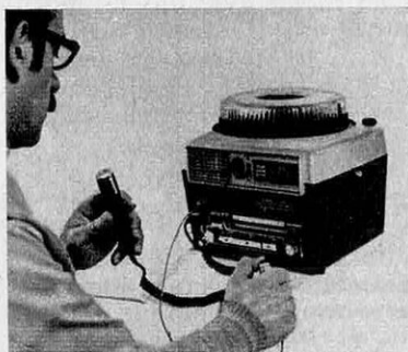
Le Teaching Dynamics : un magnétophone, un liseur de synchronisation, un projecteur, le tout en un seul bloc compact.
