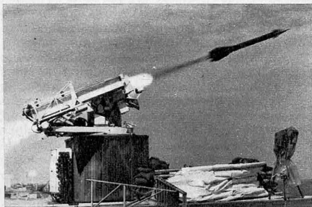
Le système d'armes Sol-Air Crotale , réalisé sous la maîtrise d'œuvre de Thomson-Houston, dont le missile est construit par Matra, équipera en 1971 les armées françaises et d'Afrique du Sud. Le système est formé de deux véhicules : le premier est équipé d'un radar de surveillance et de désignation d'objectif et d'un ordinateur digital. Il est couplé à un ou plusieurs véhicules lanceurs équipés d'un radar de tracking, d'un ordinateur digital et d'une rampe orientable permettant de tirer 4 missiles à la vitesse de Mach 2,3 sur des cibles éloignées de 8 km.
