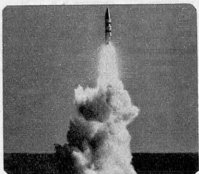
Lancement d'un Lockheed Polaris A 3, au poids de 13 600 kg et à la portée de 4 630 km, qui équipe la plupart des 41 sous-marins lance-missiles américains.
