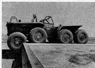
Le « Twister » escaladant un mur d'un mètre de hauteur.
