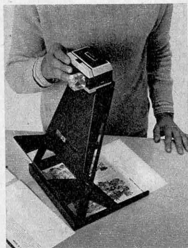
Utilisation du statif 200 × 200 mm pour la réalisation de diapositives ou de photographies.
