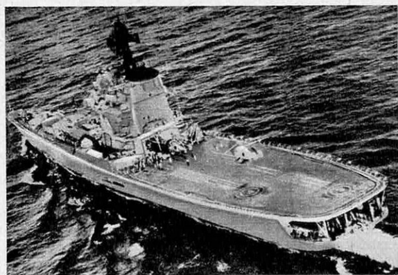
L'armement principal des destroyers « Kashin » que l'on voit ici dans un port égyptien, est composé de 2 rampes doubles pour 20 « Goa » guidés par des systèmes radars semblables à ceux installés sur les « Kynda ». Déplaçant 5 000 t avec une vitesse de 34 nœuds, ils pourraient être propulsés grâce à des turbines à gaz. Ils sont équipés d'une plate-forme pour hélicoptère assurant le guidage des missiles ou participant à la défense anti-sous-marine.
