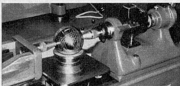
Les mesures d'ovalisation par détermination de dix diamètres différents.
