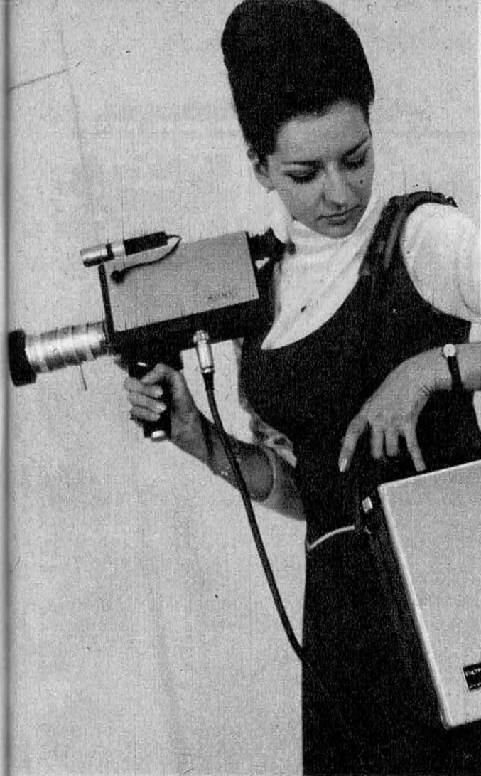
Le plus petit enregistreur d'images sur bande magnétique ; 6,2 kg avec ses accus (Sony 2400) .
