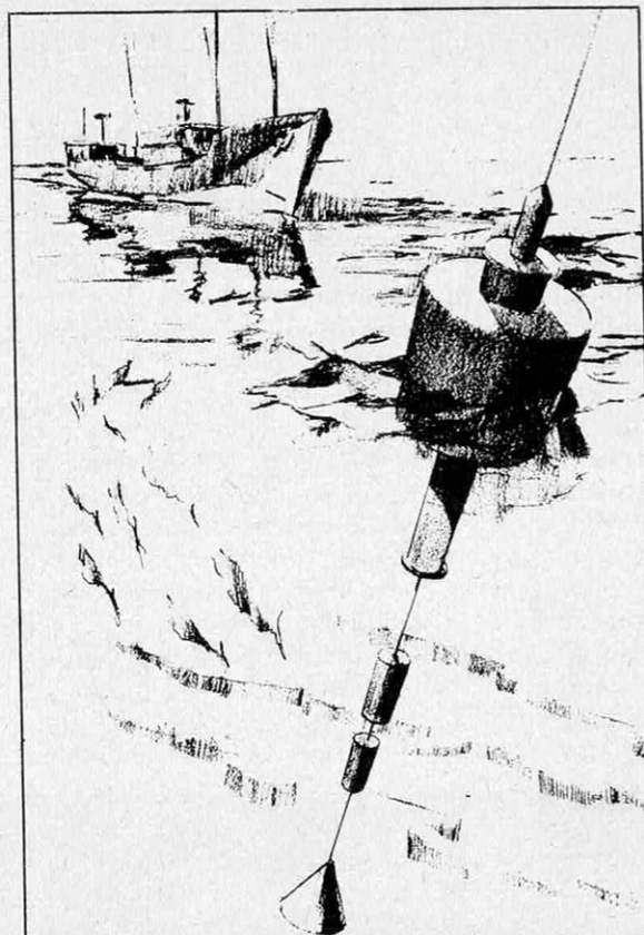
Expérimentée à bord de Gemini, la pile General Electric est capable d'alimenter pendant plus d'un an une bouée-balise radio.
