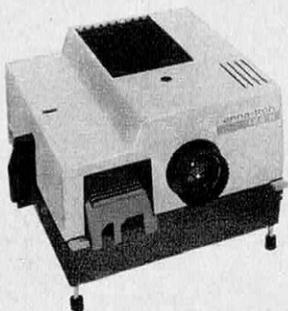
de l'Ennatron sont les suivantes : objectif 2,8/100 mm ou 2,8/60 mm; lampe halogène 24 V, 150 W, turbine de refroidissement, paniers de 36 vues. Son prix : environ 400 F.
