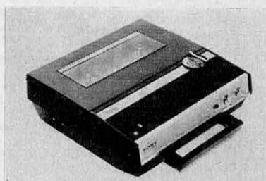
teurs, donnant une bonne reproduction (100 à 7 500 Hz à 9,5 cm/s), d'emploi très facile, grâce notamment à un dispositif « O-Matic » assurant automatiquement le réglage correct du volume d'enregistrement. Ce sont des 2 pistes transistorisés, comportant les vitesses de 4,75 et 9,5 cm/s. Ils sont alimentés par piles ou accumulateur et fonctionnent également sur le secteur.
