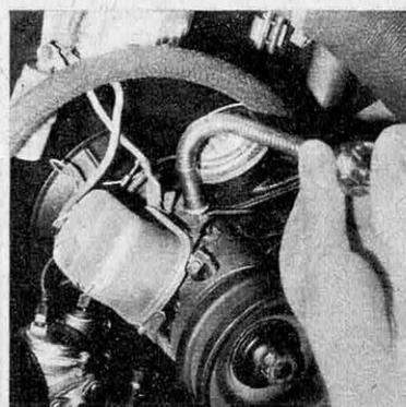
en un câble flexible, long de 36 cm et qui transmet le mouvement de la poignée à la pointe d'attaque interchangeable et qui existe en trois dimensions. Le manche, en plastique, est complètement isolé. Grâce à cet outil simple qui permet de travailler dans les coins, on peut se dispenser de l'appareillage complexe et coûteux de tournevis articulés par joints de cardan. De fabrication allemande, il est vendu 80 marks (l'équivalent environ de 100 F).
