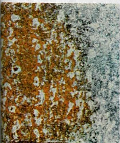
électroniques de la matière, la rouille n'est, au fond, si pernicieuse que parce que la pellicule d'oxyde de fer n'est pas étanche comme celle qui se forme sur le zinc ou le chrome. Cela dit, le courant électrique joue un rôle si important dans la corrosion que les physiciens en sont venus à l'utiliser comme premier moyen de lutte contre la rouille.
