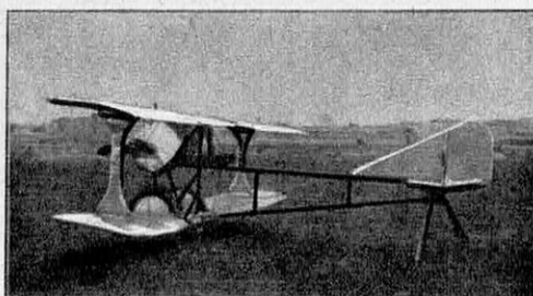
10 ch, 100 kilos plus le pilote, 110 km/h.
