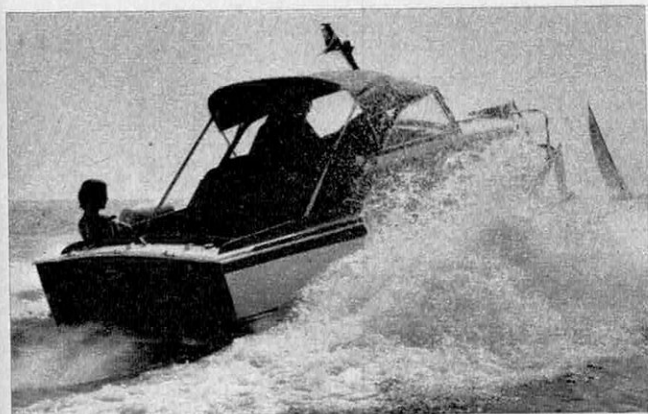
Vedette Fourtou équipée d'un moteur interne Renault-Marine, 55 ch sport à essence. Le prix de ce moteur est de 5 200 F
