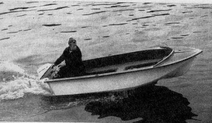
« La Ballade » de Mazura Marine. La coque insubmersible en plastique stratifié fait 3,30 m, peut supporter un moteur de 3 à 6 ch et coûte 1 090 F.
