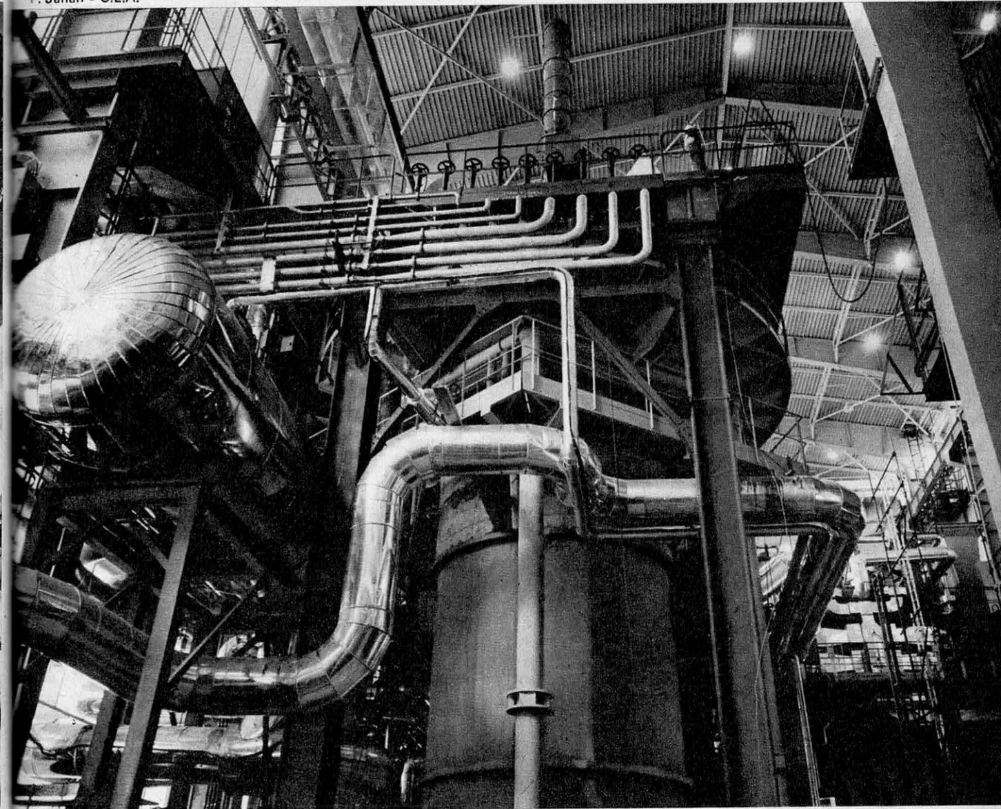
Hall des essais de Rapsodie. Maquette du bloc pile: cuve et réservoir de charge.
