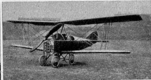
Le Potez-Coroller : un moteur de 50 ch qui emporte 160 kg de charge. 3 heures d'autonomie de vol.
