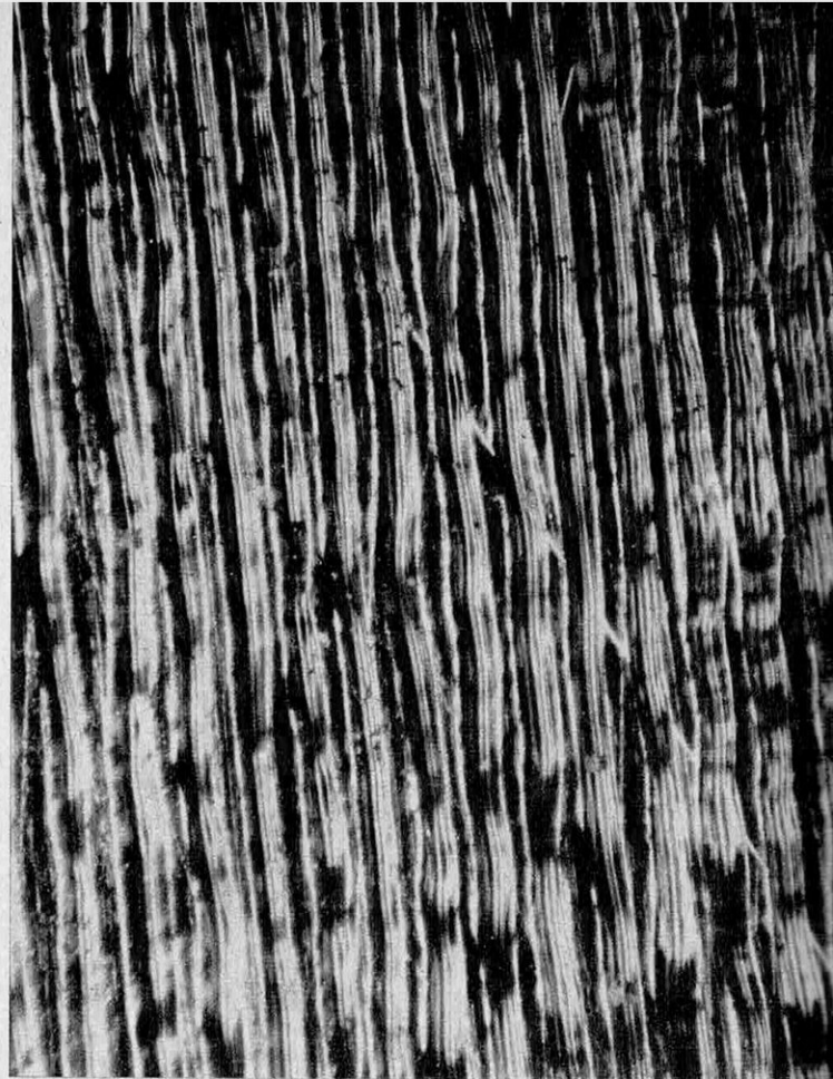
Le microsillon : il exige des aiguilles collant bien à la piste, sans souplesse verticale.
