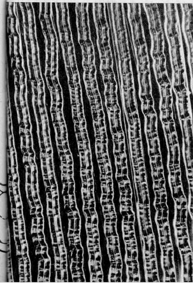
Le sillon stéréo : des méandres complexes situés sur les deux rives.
