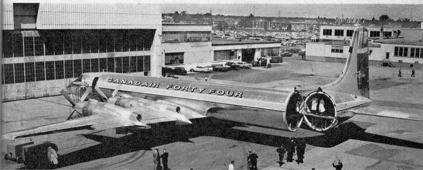
Le Canadair CL-44 « Forty-Four », un avion cargo quadriturbopropulseur de 95 000 kg à chargement par l'arrière.
