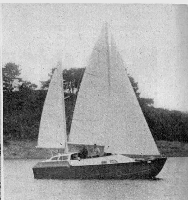
La « Bête » d'Yves Betin. Au moteur, la dérive et le safran de gouvernail sont remontés dans la coque. Elle déjauge. Sous voile, c'est un parfait voilier. Ci-dessous schéma d'équipement.
