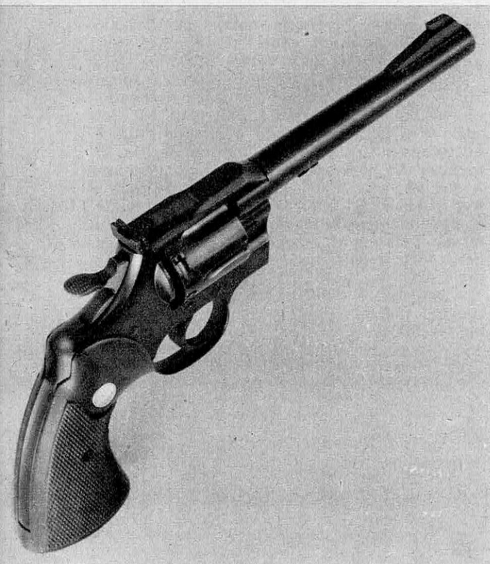
LE COLT Officers Model Match. Revolver à 6 coups au calibre 38 spécial, doté d'un canon de 15 cm, le Colt OMM est, avec le Smith & Wesson K 38, le type même du revolver de match. La hausse est réglable, la crosse est large et le départ est exceptionnellement bon.
