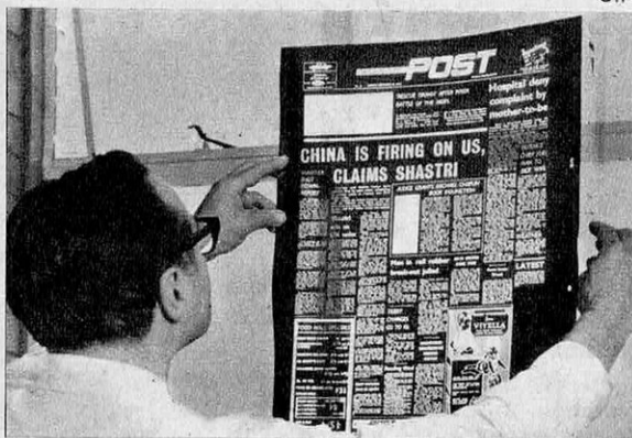
Les textes photo-composés, tirés sur papier « bromure », sont assemblés pour la mise en page. La page est ensuite reproduite sur feuille transparente, qui servira à préparer la plaque imprimante.
