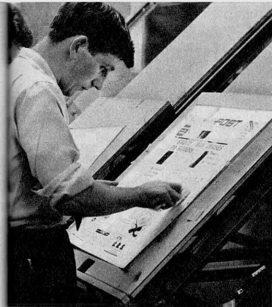
Les textes photo-composés, tirés sur papier « bromure », sont assemblés pour la mise en page. La page est ensuite reproduite sur feuille transparente, qui servira à préparer la plaque imprimante.
