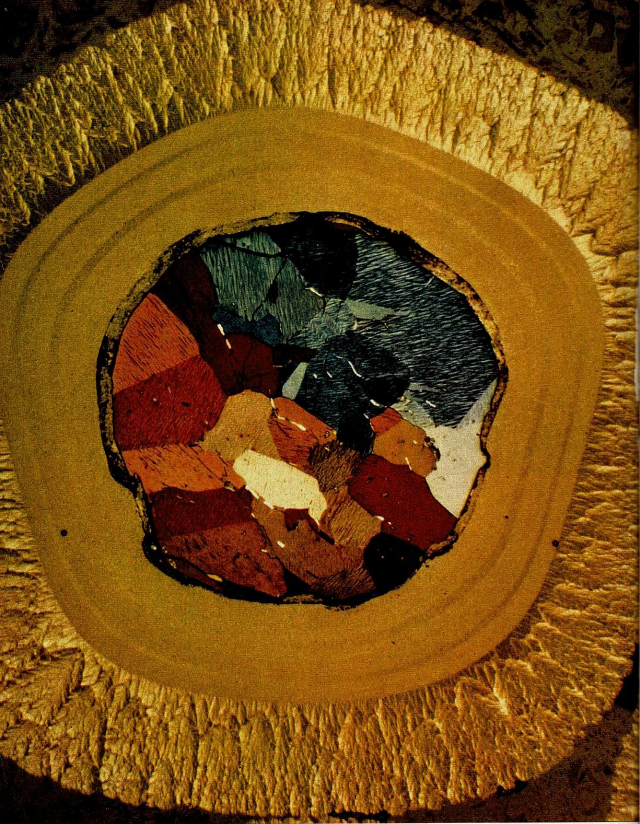
Grossie 370 fois, voici une particule de carbure d'uranium, UC_2 , coupée par le milieu. Des millions de particules enrobées ainsi pour retenir les produits de fission dangereux, servent de combustible à la pile « Dragon ».
