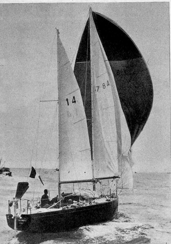
Dans la traversée victorieuse de l'Atlantique, Eric Tabarly sur son « Pen Duick » a, comme sur les trimarans de croisière, utilisé une barre intérieure ainsi qu'une voilure ketch à deux mâts.
