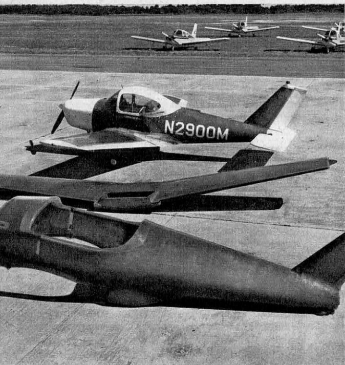
L'avion « tout plastique » vient de voir le jour. Réalisé par Piper, le PA-29 « Papoose » se compose de deux coques — voilure et fuselage — en sandwich stratifié.
