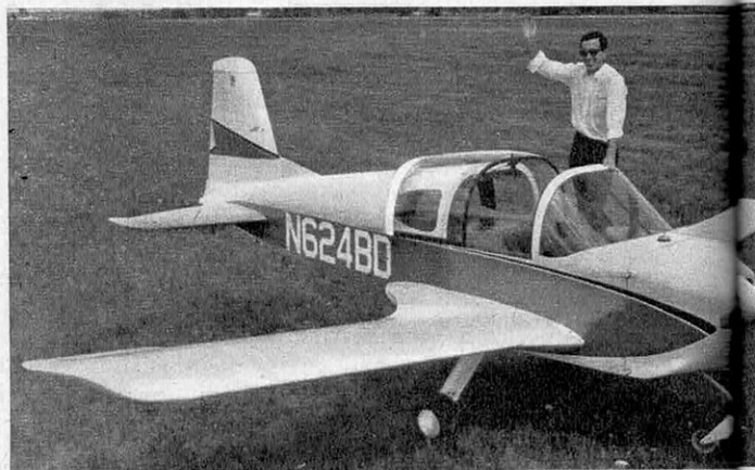
Jim Bede compte sortir à 2 500 dollars (12 500 F) son BD-5 petit biplace de 65 ch, réalisé avec de grands panneaux en nid d'abeille d'aluminium assemblés par collage.
