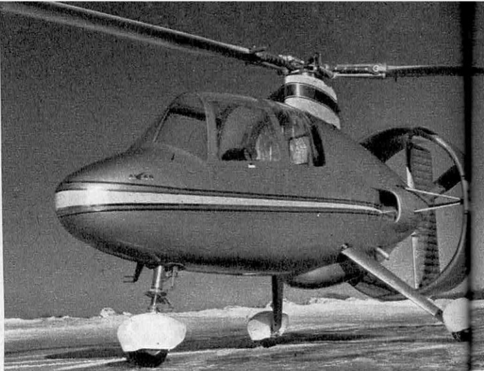
Le plus perfectionné des autogires : « l'Avian » canadien. C'est un biplace de 180 ch avec rotor tripale à pas variable permettant le décollage « sauté ».
