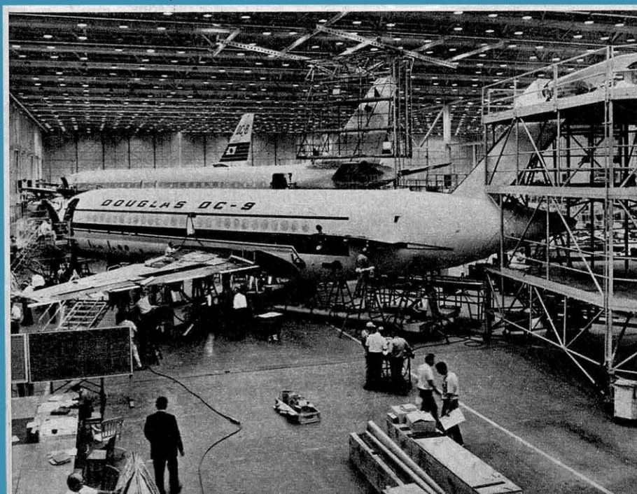
Novembre 1964 : On raccorde tuyauteries, câbles et commandes de vol sur l'avion entier.
