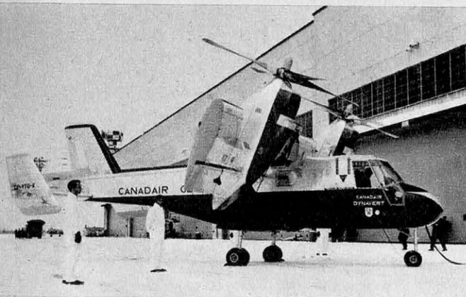
Le « Dynavert » canadien (CL-84) avec sa voilure et ses moteurs basculés aux trois-quarts.
