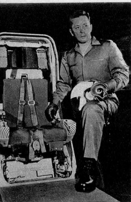
Ci-contre : Al White, chef pilote du BX-70, auprès du nouveau type de siège éjectable pouvant servir tout à la fois de canot pneumatique ou d'abri de « survie » dans le désert. Ci-dessous, le train d'atterrissage du BX-70. La petite roue centrale mesure la vitesse au sol et déclenche automatiquement le système de freinage.
