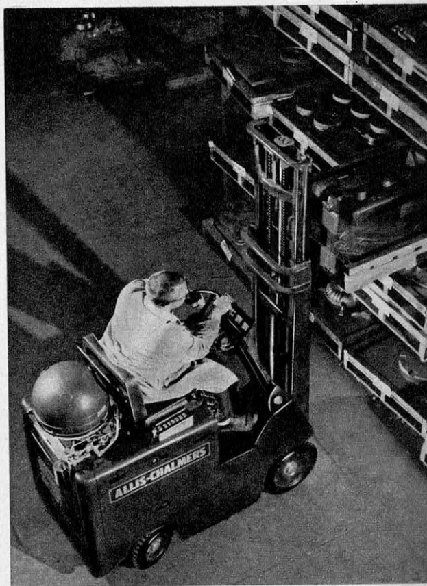
La «fuel-cell» de ce tracteur est toujours à demeure : il suffit de faire le plein de combustible.
