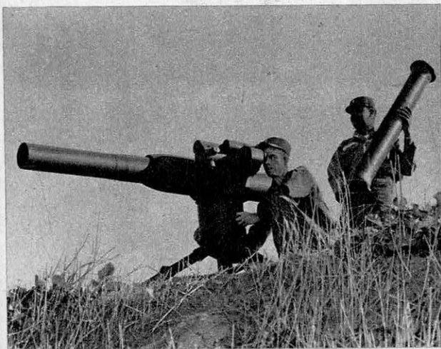
Le Tow, construit par Hughes, est la première combinaison de l'engin-fusée, téléguidé par fil, et du canon comme arme anti-chars.
