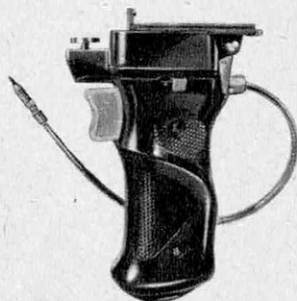
Poignée-crosse. — Commode à saisir, déclenchement par gâchette et déclencheur flexible, permettant de tenir le Rollei et de déclencher avec la main droite. La main gauche reste libre pour la mise au point.
