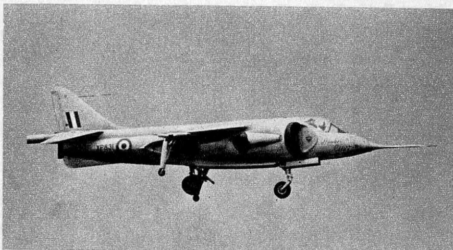
Premier en date des VTOL de combat modernes, le Hawker 1127 n'a devant lui qu'un avenir limité. L'orientation variable de ses tuyères lui permet de décoller sur l'herbe sans ennui.
