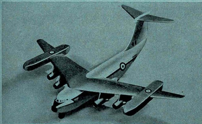
Le plus gros V-STOL du monde, le Hawker-Siddeley 681, existera en deux versions: STOL avec quatre réacteurs à flux orientable; VTOL, avec des réacteurs de sustentation.
